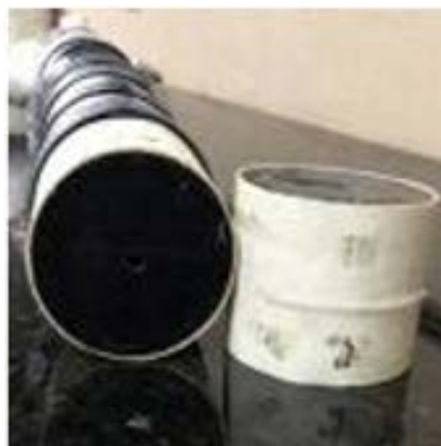
(b) Orifício dentro da tubulação
