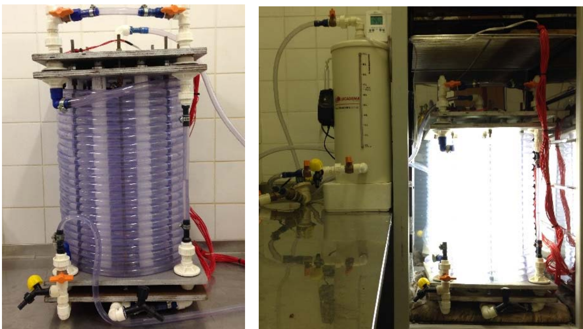
Figura 6. Imagem do reator proposto e do sistema em operação, respectivamente
