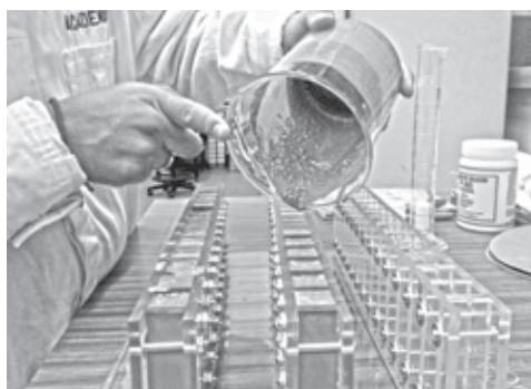
Dimensiones de las probetas fabricadas para pruebas a flexión de 3 puntos. Fabricación y desmolde de las probetas de cemento básico y cemento con aditivos
