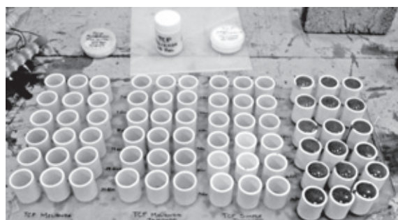
Dimensiones de las probetas fabricadas para pruebas a compresión. Elaboración de moldes y vaciado posteriormente con mezclas de cemento Portland y cementos con aditivos
