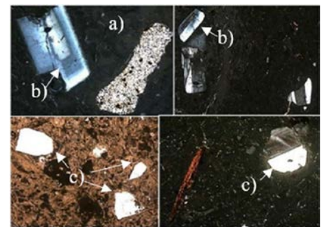
Petrografía de VMA cuya mineralogía es muy similar a la CVS. Las variaciones principales son los tamaños de los cristales: a) se observa la matriz vítrea con algo de arcillas; b) plagioclasa con textura de líneas de macla; c) fenocristales y microcristales de cuarzo y feldespatos, donde la diferencia está en el contenido de silicatos. Fuente: Elaboración propia
