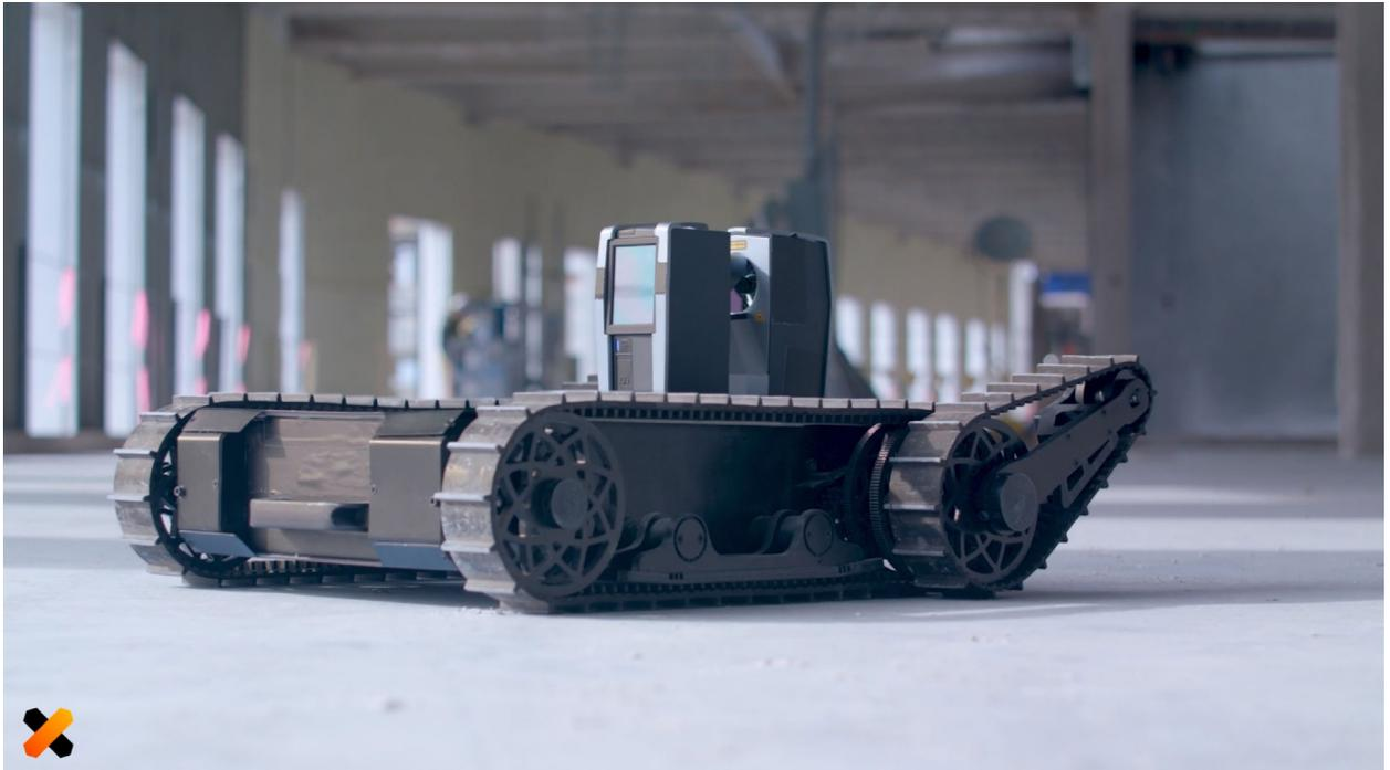
Volvo, HX02, vehículo autónomo de volcado de material, 2018. Fuente: AB Volvo, Construction Equipment Global
