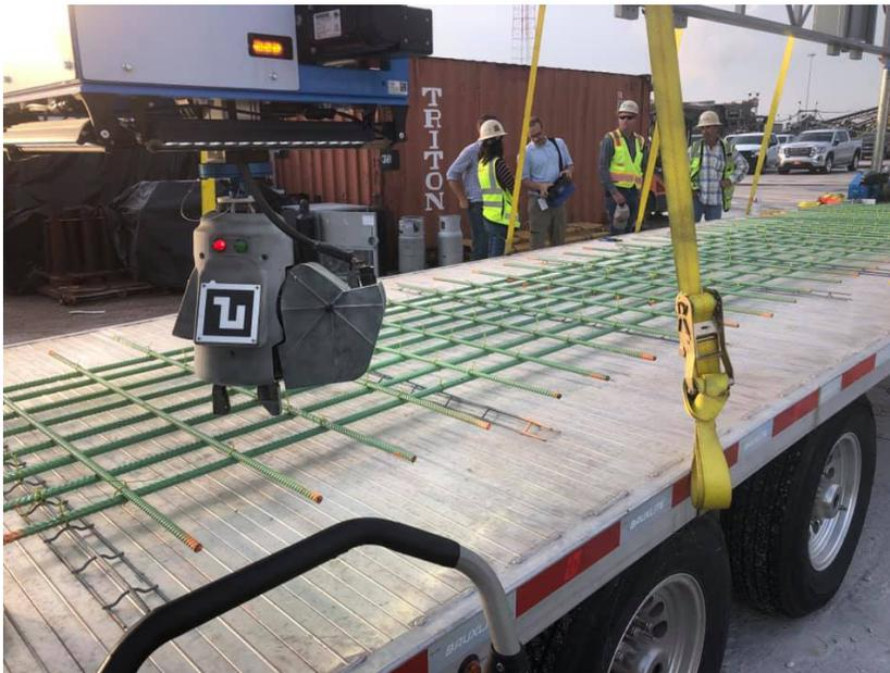
un dispensador de ladrillos y un dosificador de mezcla a base de mortero como adhesivo para su colocación. También han desarrollado la 'Mula' o Unidad de apoyo en la carga de material (MULE · *Material Unit Lift Enhancer*) el cual se configura como un sistema de asistencia de carga de piezas de hasta poco más de 60kg.<sup>38</sup>
