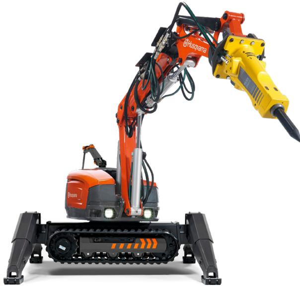
Husqvarna. Robot de demolición DXR 310, 2018. Fuente:Husqvarna AB
