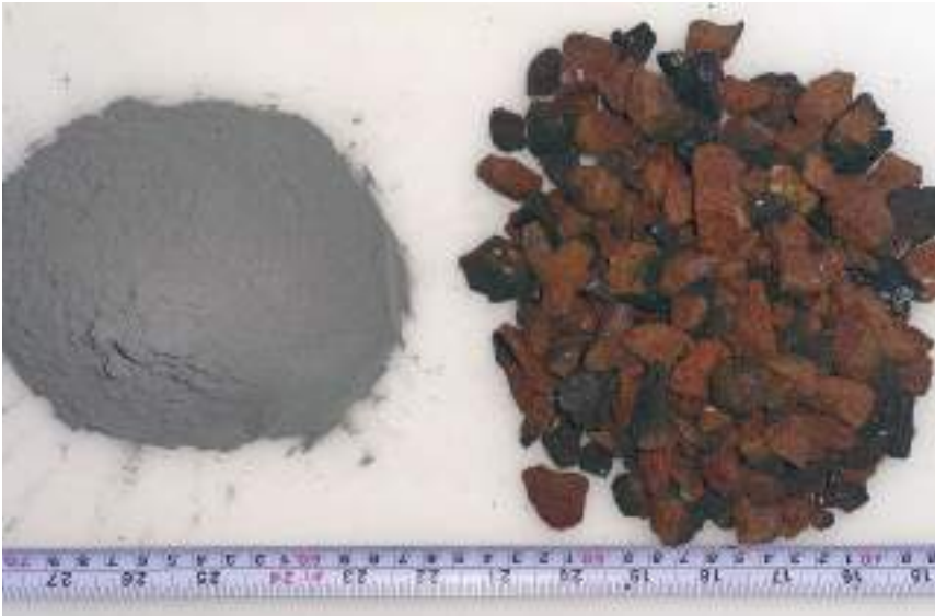
Figura 3. Agregado reciclado de arcilla termoexpandida y ceniza de bagazo de caña de azúcar.
