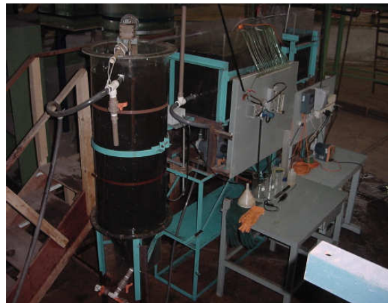
Figura 2: Vista da unidade piloto de lodo ativado (antes da instalação dos tanques de \text{FeCl}_3 e polímero)
