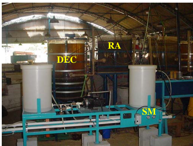
Figura 1 - Sistema de Lodos Ativados composto por Reator Aerado (RA) e Decantador (DEC) junto a Sistema de Membranas (SM).
