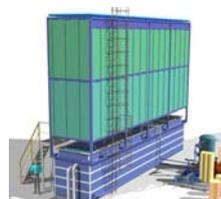
La estación completa es transportable en dos partes: unidad base en un contenedor, y estructura del filtro biológico desarmando (placas y perfiles) en otro contenedor. Es construida en PRFV-Pultrurado con opción de uso de lonas para el revestimiento del filtro biológico.
