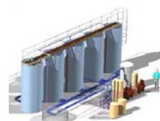
La estación menor (10 m<sup>3</sup>/h) es transportable en forma horizontal en un contenedor de 20 pies (1 módulo de 1.26 m de diámetro y 4.5 m de altura); mientras que la estación más grande (150 m<sup>3</sup>/h) es transportable en dos contenedores de 40 pies (5 módulos de 2,39 m de diámetro y 3,6 m de altura). El material por excelencia para estas unidades es el acero inoxidable AISI 304; como alternativa económica se desarrollan los módulos en Poliéster Reforzado construidos por Rotomoldeo.
