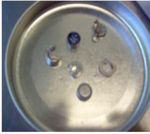
**Figura 4. Corte, disección y separación de los componentes de las pilas botón.**
