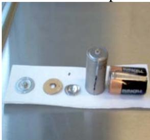
**Figura 6. Corte, disección y separación de los componentes de las pilas Duracell.**
