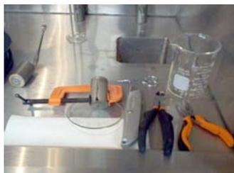
**Figura 2. Equipo utilizado para corte, disección y separación de los componentes de las pilas.**
