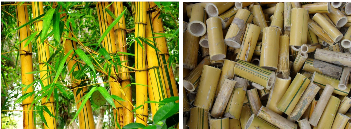
Figura 3. Material suporte (Bambu) do filtro anaeróbio
