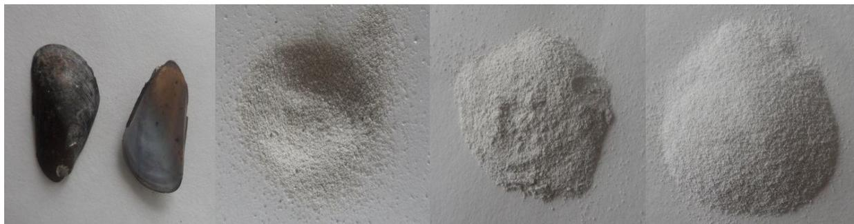
**Figura 1.** Fotos do marisco *Brachidontes solisianus* (a) inteiro, (b) classificado a 60 mesh, (c) a 100 mesh e (d) a 140 mesh
