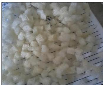
**Figura 3.** Espuma de poliuretano cortada, usada como meio suporte do RAI.
