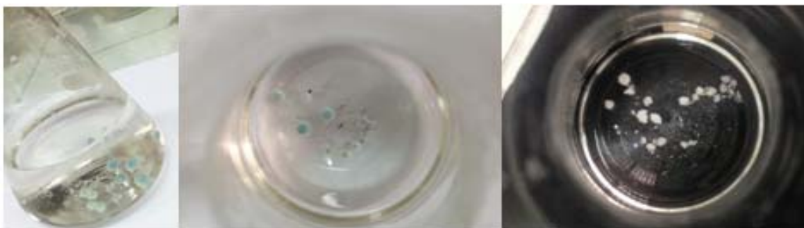
Figura 5. Formación de "pellets" nos reatores utilizados nas bateladas agitadas
