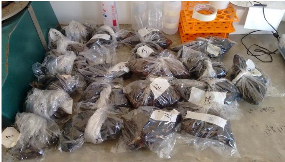
Figura 8. Amostras obtidas na região de cada termopar na leira de compostagem
