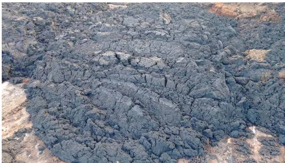
Figura 2. Lodo de esgoto centrifugado após receber polieletrolito
