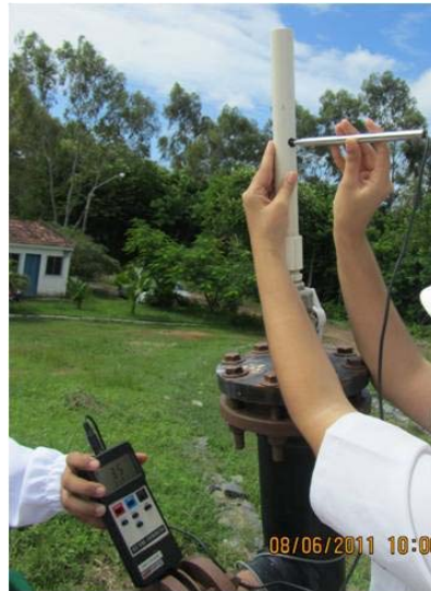
Figura 4. Monitoramento da vazão do biogás dos drenos.
