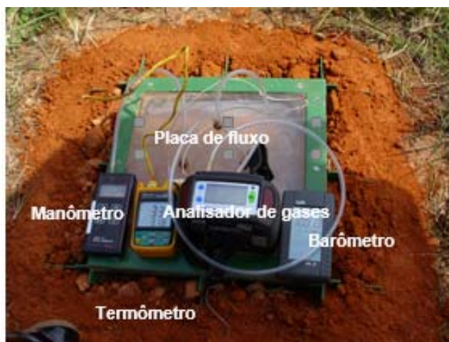
Figura 5. Equipamentos utilizados nos ensaios de placa de fluxo.
