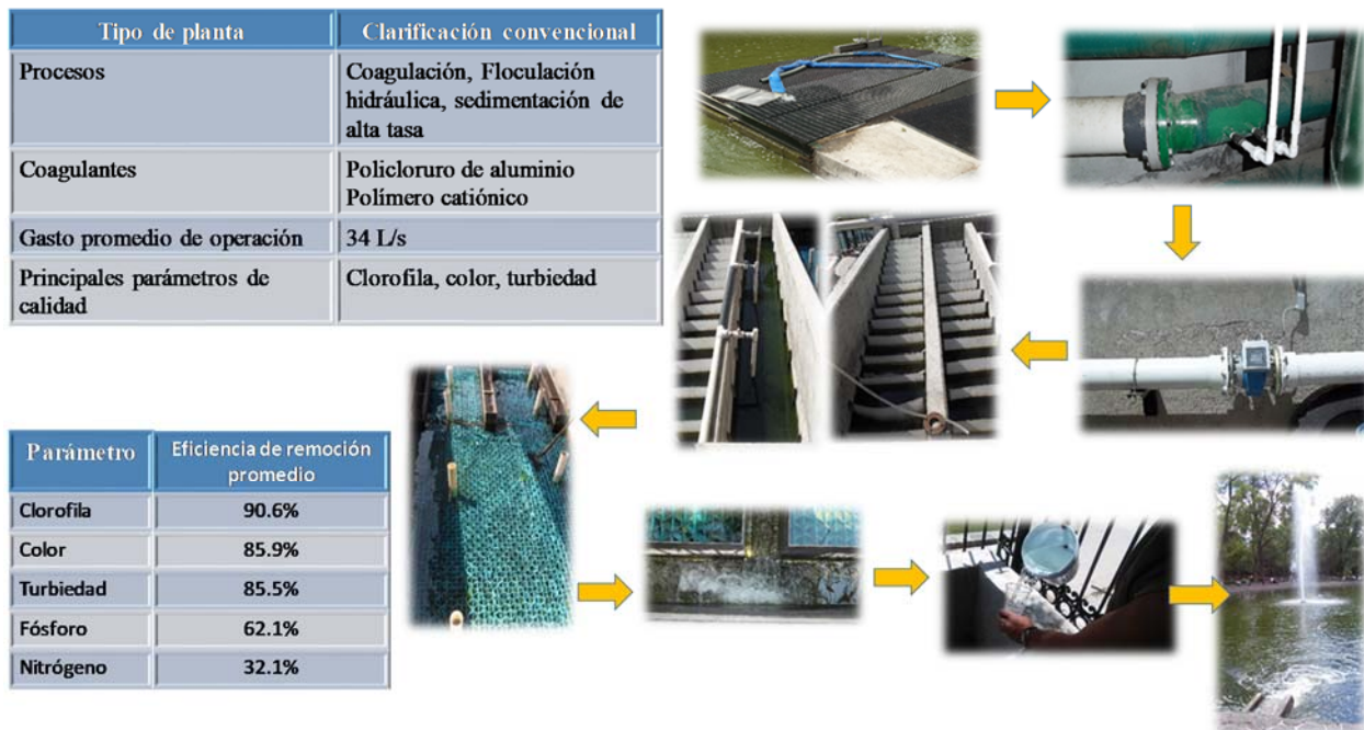
Figura 1. Planta Piloto coagulación-floculación-sedimentación y eficiencias de remoción.
