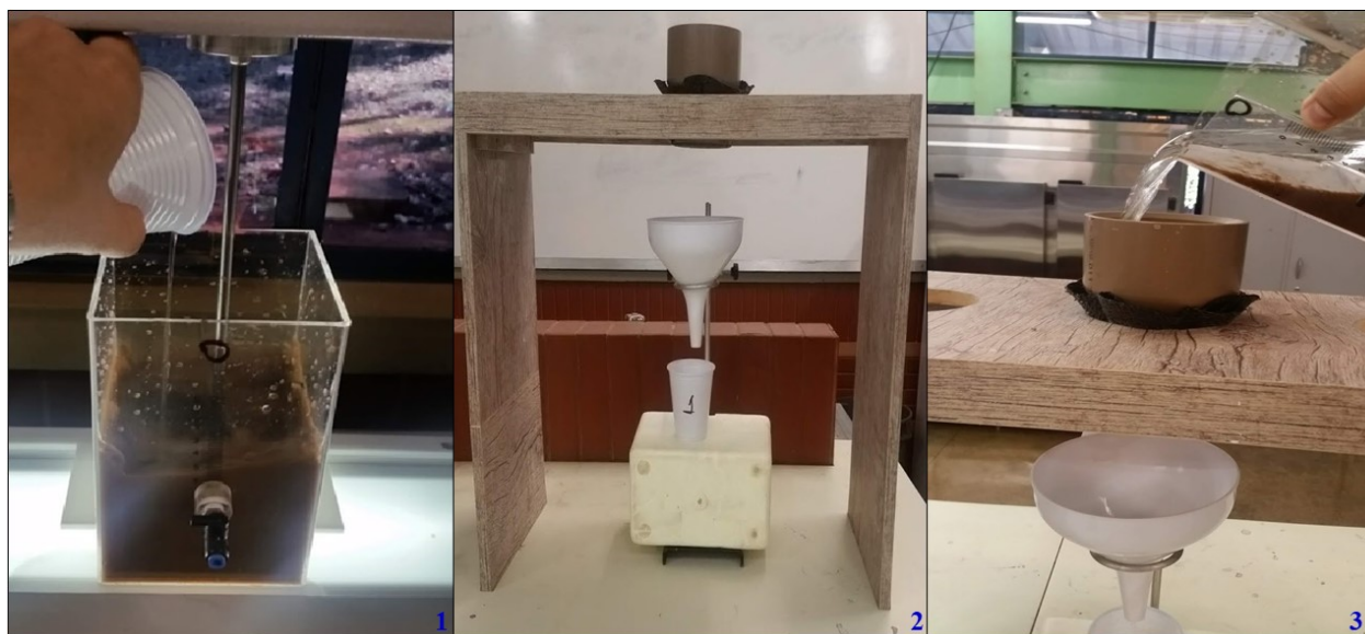
Figura 5. Ensaio de bancada em geotêxtil: adição de polímero na mistura rápida (1), sistema de bancada de filtração em geotêxtil (2) e desaguamento do resíduo (3).
