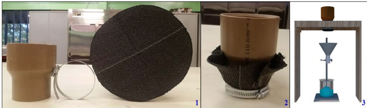
Figura 4. Sistema de filtração de bancada em geotêxtil: redução em PVC de diâmetro de 75x50 mm, abraçadeira metálica e tecido geotêxtil (1) e kit de filtração (2 e 3).
