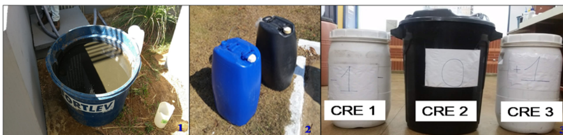
Figura 3. Preparo da concentração do resíduo de estudo: resíduo do decantador (1), coleta de água filtrada da ETA006 em bombonas para realizar as diluições (2), concentração de resíduo de estudo preparada (3).
