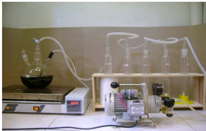
Figura 2. Aparato experimental para coleta dos gases de evaporação
