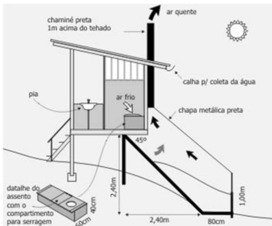
Figura 1. Esquema de funcionamento de sanitário seco compostável – alvenaria.
