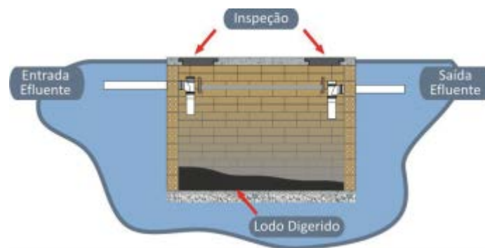
Figura 4. Esquema com os principais componentes de um tanque séptico.
