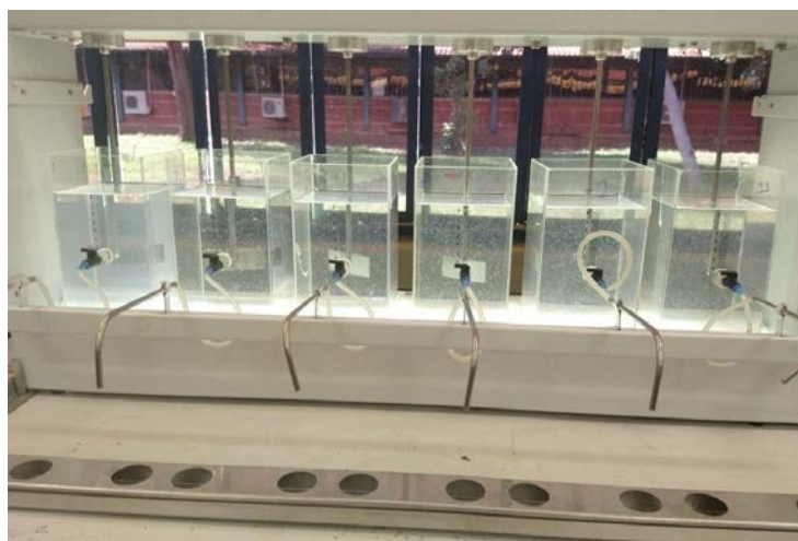
Figura 02. Equipamento de Teste de Jarros ( Jartest ) utilizado para o teste de coagulação da amostra. Fonte: Acervo dos autores. Fonte: Autores (2019).
