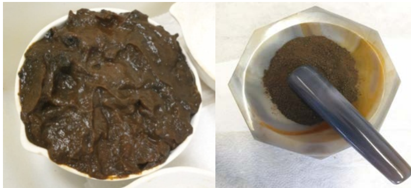
Figura 1. Lodo úmido à esquerda e lodo seco em proceso de trituração à direita.
