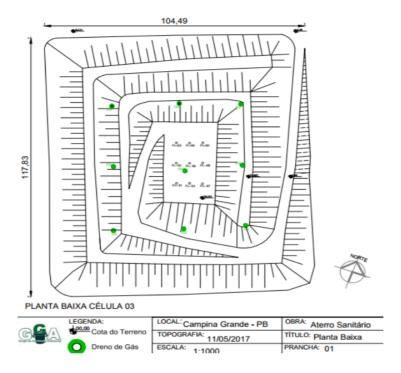
Figura 1. Planta baixa da C3 construída no ASCG
