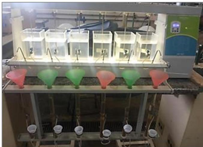
**Figura 1.** Equipamento jarreste acoplado aos filtros de laboratório de areia.
