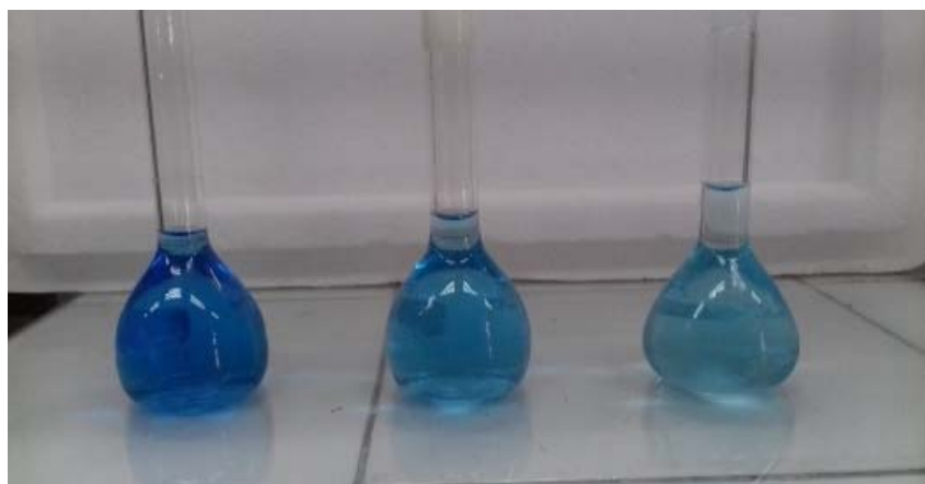
Figura 4. Verificação da redução de cor em amostras de entrada (0h), metade do tempo reacional (24h) e saída (48h).
