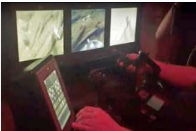
Figura 15. Visualización detallada de la operación en tiempo real de una excavación robótica en el mar Negro a una profundidad de 2 122 metros: a) demostración del uso del brazo kinesiológico (mano derecha del piloto) desde el centro de comando en el buque investigación y b) el manipulador robótico de titanio TITAN4 recibiendo el movimiento preciso del operador por medio de fibra óptica el cual opera la draga de excavación a más de 2 000 m de profundidad.
