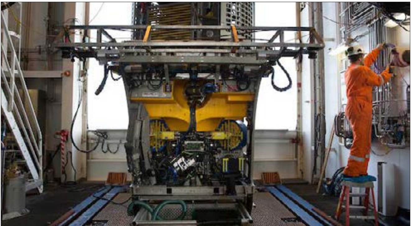
Figura 7. Shilling Robotics HD vehículo remoto de clase industrial (WROV) preparado por los ingenieros de MMT en una de las numerosas inmersiones en el mar Negro. Fuente: Fotografía Jodi Hilton.
