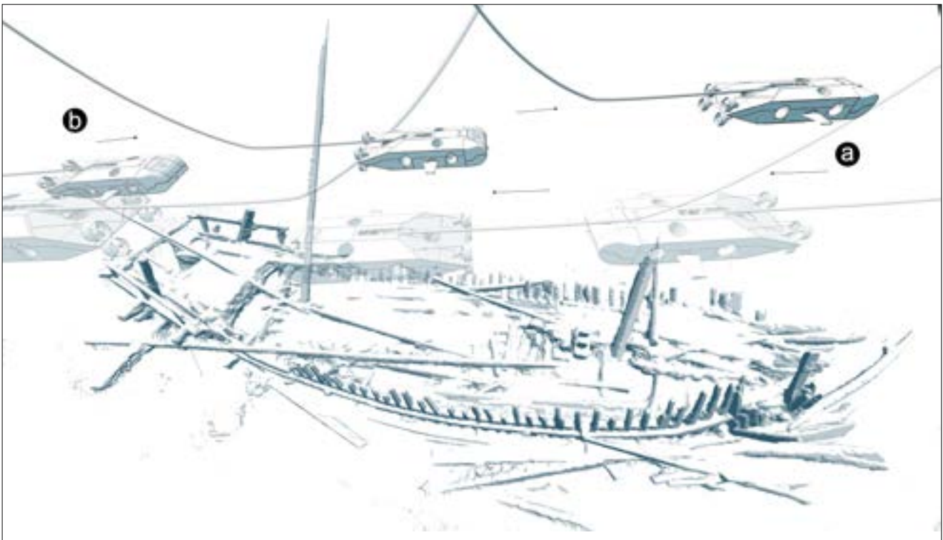
Figura 10. Método de prospección fotogramétrica, utilizando el SROV, en sitios más sedimentados y más someros con respecto al lecho marino: a) primer línea base de prospección y b) segundo “vuelo” añadiendo detalle al sitio.
