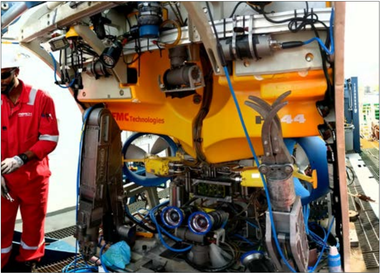
Figura 25. Configuración de fotogrametría estereoscópica montada en el wROV para mapear la embarcación del siglo XVI en el mar Báltico.
