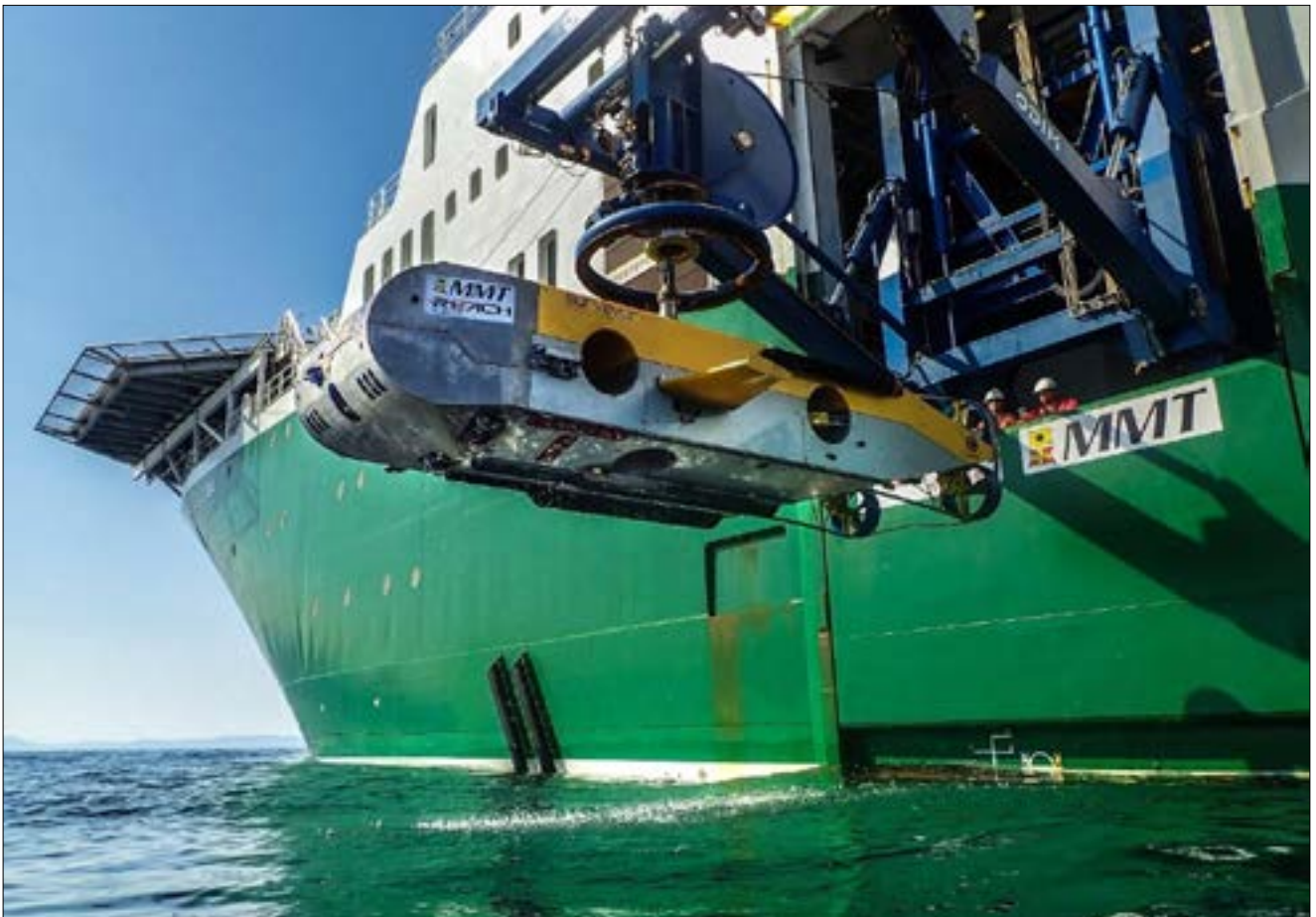
Figura 8. SROV lanzado desde MPSV Havila Subsea. Fuente: Fotografía Joakim Holmlund.
