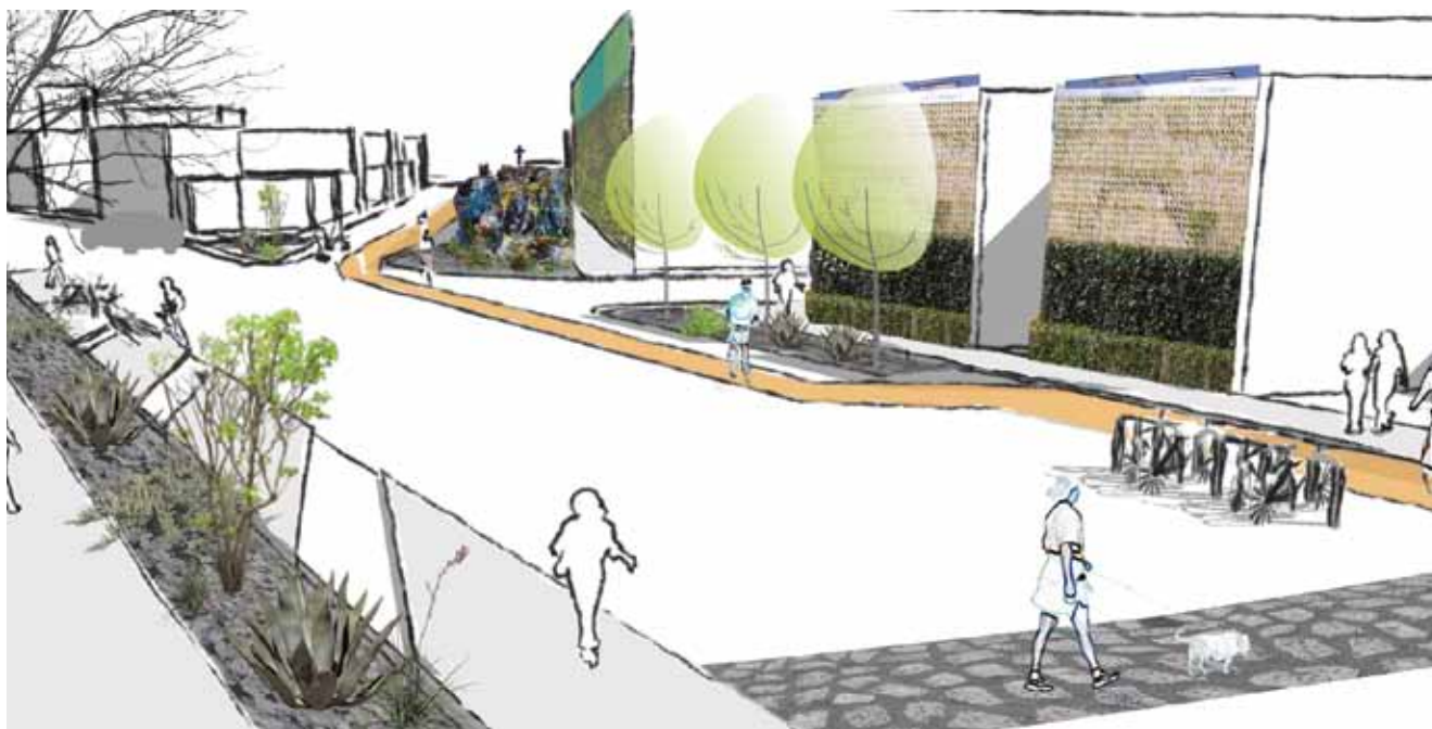
Intervención esquinas. Prototipo constructivo de ampliación de banqueta con xerojardinería para la infiltración del agua de lluvia
