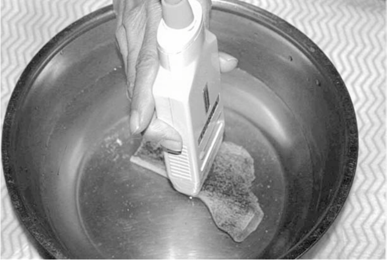
Figura 8. Ultrasonido de segmentos óseos con técnica de inmersión y transductor lineal de 7.5 mhz.
