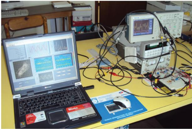
Figura 9. Maqueta experimental para probar en tiempo real la sincronización atípica de dos circuitos de Lorenz desacoplados
