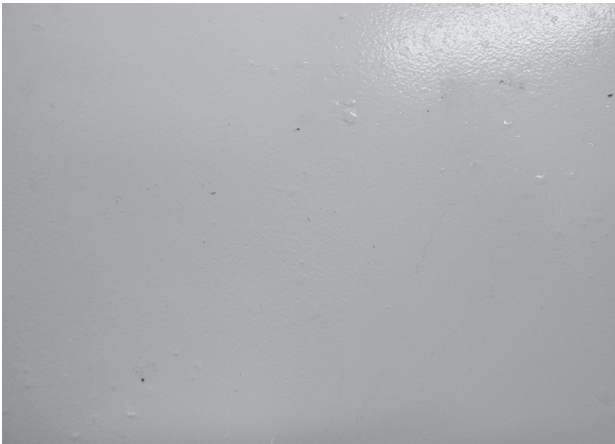
Figura 5. Foto de la muestra MR23, tras 1000 horas de exposición en niebla salina neutra
