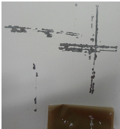
Figura 7. Foto donde se evidencian los resultados del ensayo de adherencia, muestra MR24
