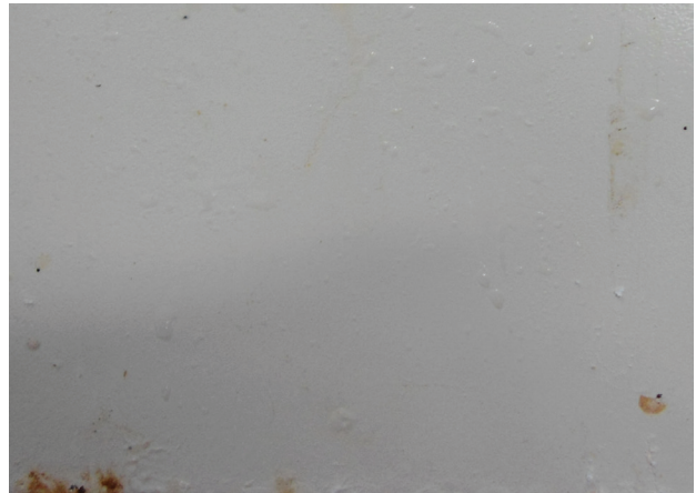
Figura 6. Foto de la muestra MR24, tras 1000 horas de exposición en niebla salina neutra
