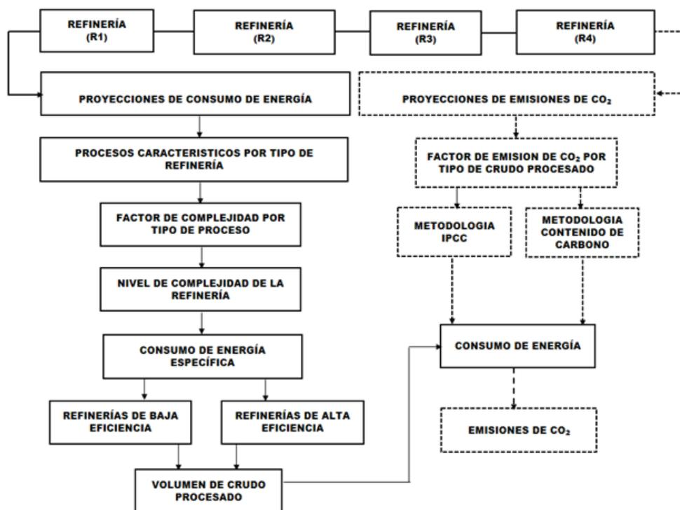
Figura 1. Diagrama de flujo de la metodología para las diferentes proyecciones de consumo de energía y emisiones de CO<sub>2</sub>
