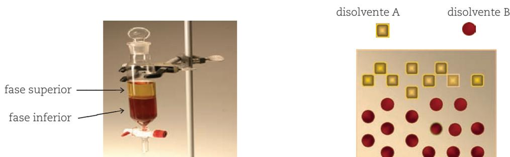
Figura 2. Vista macroscópica y representación microscópica del proceso de formación de una mezcla heterogénea de dos líquidos.
