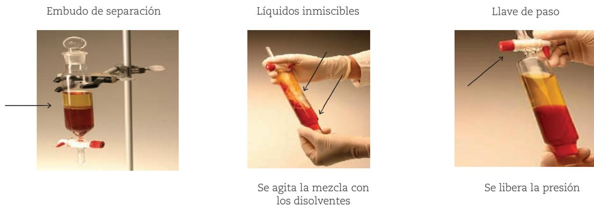
Figura 3. Extracción simple líquido-líquido.
