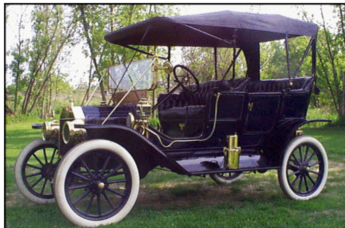
Figura 1. Debido a su gran dureza y resistencia, Henry Ford utilizó acero de vanadio en su famoso Modelo T. (Foto tomada de: http://www.modelt.ca/background-fs.html )
