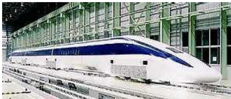
Figura 4. El tren japonés Yamanashi MLX01-MagLev funciona gracias a levitación magnética (aunque cabe mencionar que los superconductores que usa no están hechos a base de óxidos de cobre). Este tren puede alcanzar una velocidad de hasta 343 millas/hora (tomado de http://superconductors.org/Uses.htm ).
