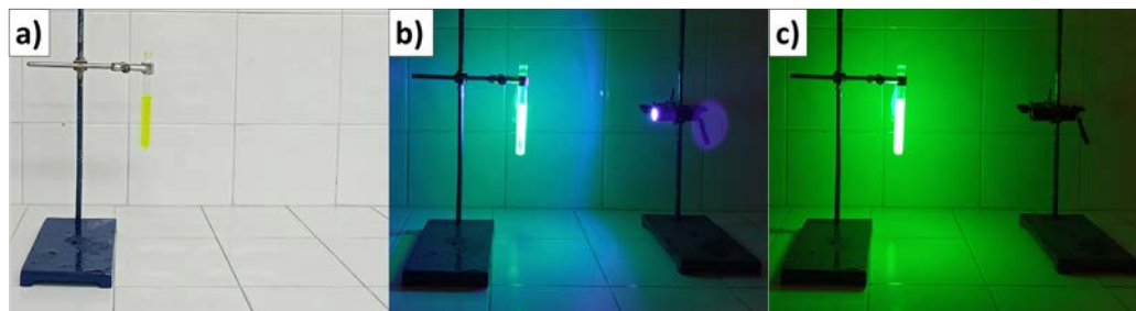
FIGURA 14. Solución del compartimiento interno del producto barras de luz a) expuesto a luz ambiente, b) expuesto a luz UV y c) después de adicionar solución de peróxido de hidrógeno al 30% m/v.
