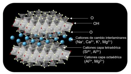
FIGURA 2. Estructura de la montmorillonita, modificada de wikimedia. org.
