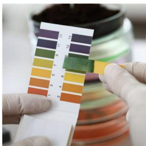
**FIGURA 3.** a) Estimación visual del pH de una disolución mediante el color de tiras de papel indicador. b) Detalle del cuaderno de laboratorio del alumno.
