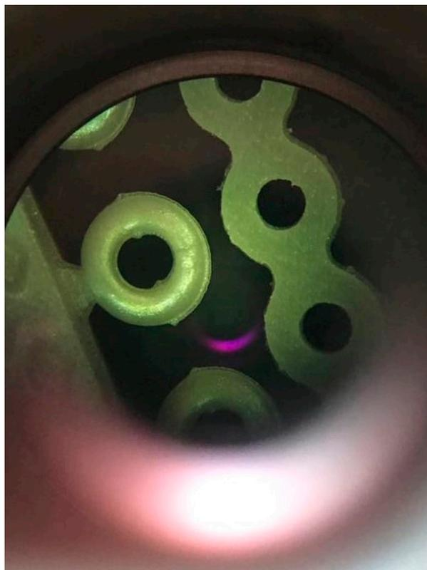
Figura 1. Imagen de microscopía óptica de módulo elastomérico 3M (inyección) y cadena elástica 3M (estampado).
